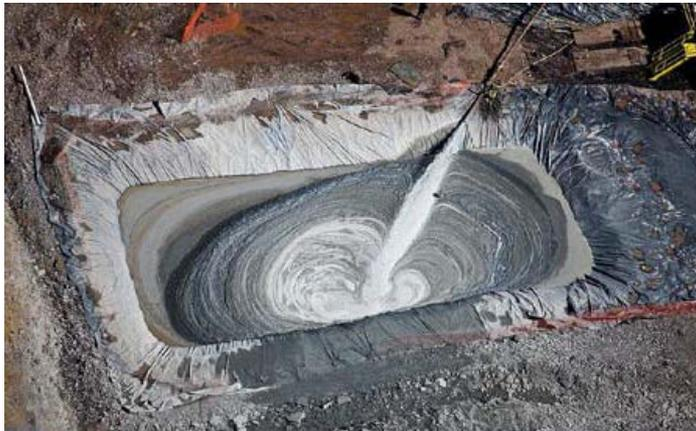
**Fuente:** J. Henry Fair. Vertido en balsas de de agua con compuestos químicos recuperados después de realizar el fracking.
